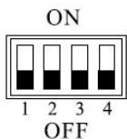
Установка частично описана выше, (см. п.п. 3.3, 3.4) Вам осталось выставить только **dip2**. При выключенном **dip2** ворота работают «открыть – стоп – закрыть». Если **dip2** включить, то при нажатии на кнопку однокнопочного управления или брелок, при закрывании ворота сразу пойдут в противоположную сторону, а при открывании нажатие на кнопку игнорируется.
